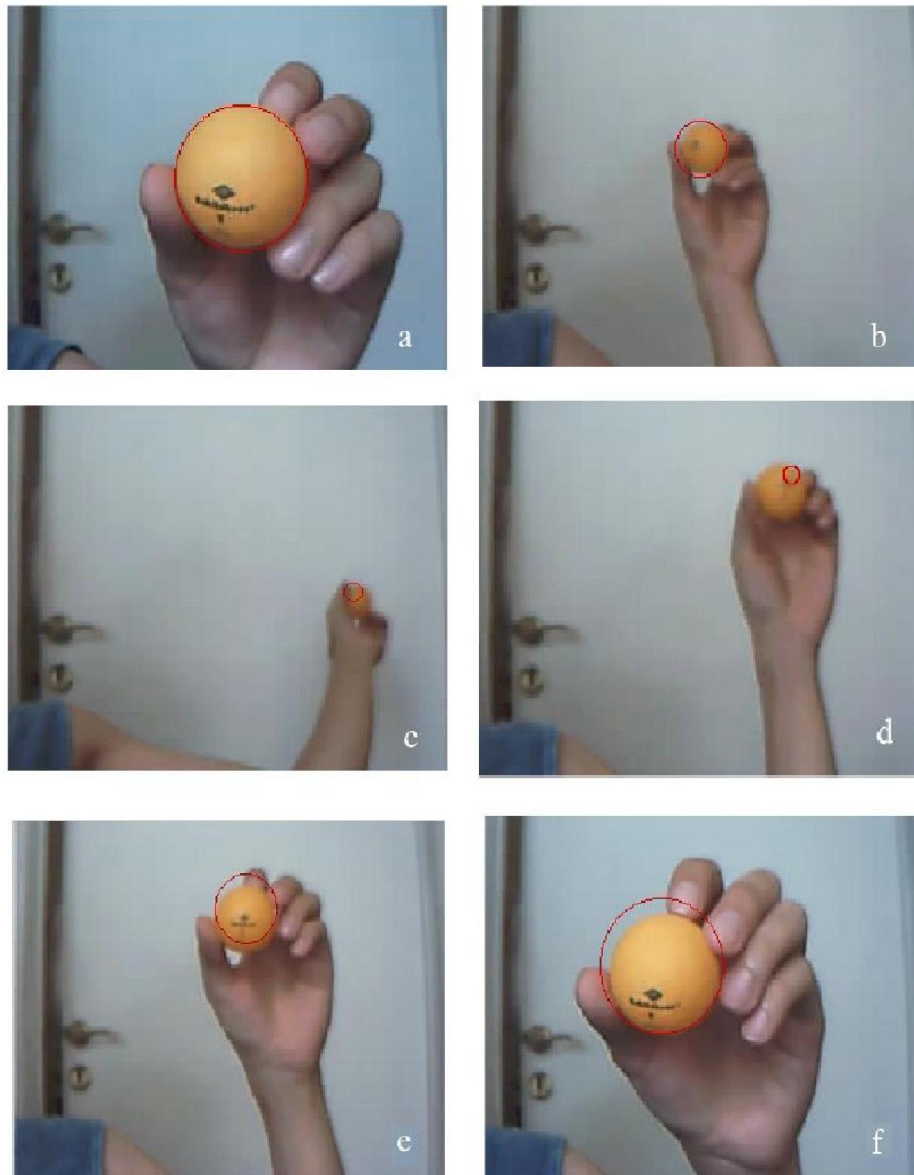
Figura 6.7: Alejamiento y acercamiento de un objeto uniforme. Los frames mostrados son 16, 176,339, 600, 695, 800. En los tres primeros frames el objeto se aleja respecto de la cámara mientras que en los tres últimos se acerca. En el cuarto frame el objeto se acerca pero el algoritmo todavía no lo ha detectado.
